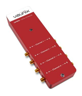
虹科HK-LDA系列数字衰减器为微波测试台带来了经济性、功能性、可靠性和简单性。频率 覆盖范围从6MHz到40GHz,最大输入电平为2W,步长小至0.1dB。
